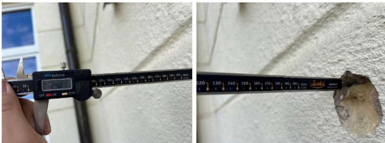
20, 21 pav. Išorinių sienų tinko sluoksnio matavimas
