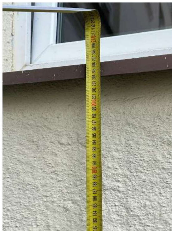
13,14 pav. Išmatuotas aukštis nuo grindinio iki pirmojo lango – 2,06 m
